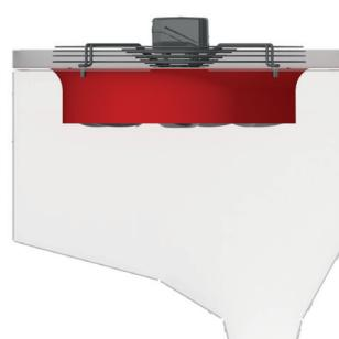
Kaikki AXI-laitteet on varustettu integroidulla puhallindiffuusorilla, mikä vähentää pyörteistä ilmavirtausta laitteen sisällä ja lisää siten kokonaisilmamäärää. Tämä ominaisuus myös vähentää puhaltilien aiheuttamaa melua. Integroidun puhallindiffuusorin ansiosta laite on täysin ERP 2015 -säännösten mukainen.
